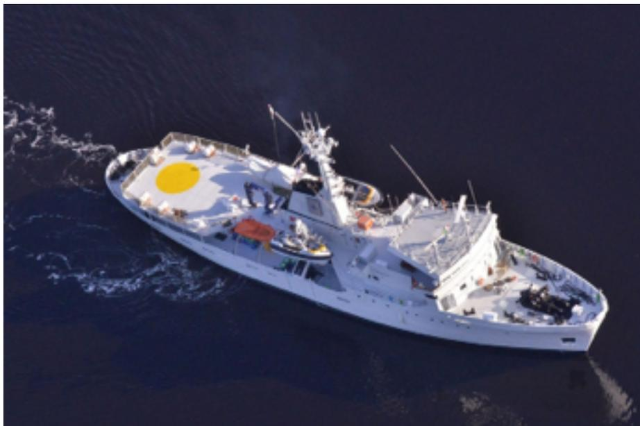
Schiffsgrösse: Länge 56 m, Breite 10,6 m, GRT 871, Tiefgang 3,5 m
